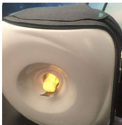
Биопринтер на магнитной ловушке в рабочем состоянии со вставленным сфероидом (фото 3D Bioprinting Solutions)
